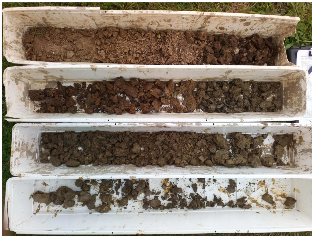
Obr 2: Vrtné jádro – JV1 (vlevo nahoře 0, v pravo dole 4,0 m)
